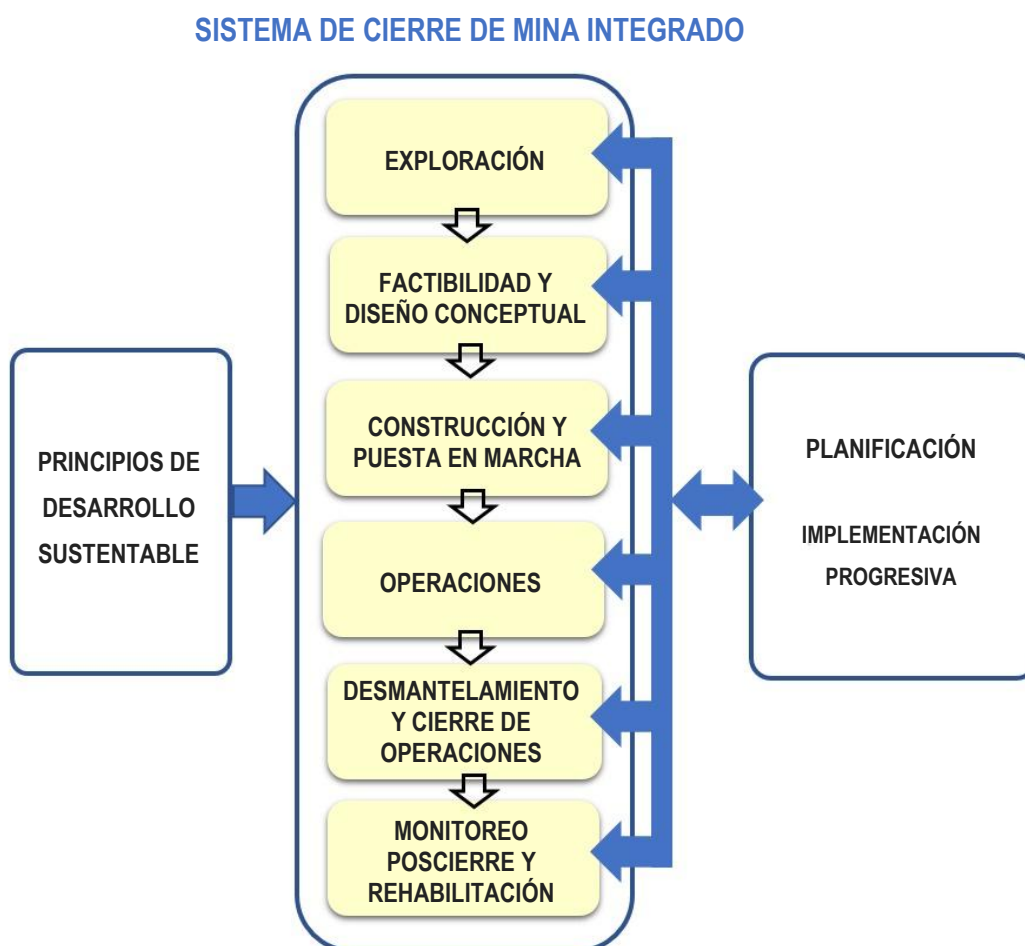
Figura 3. Fases de un proyecto minero integrado en un sistema de cierre.
